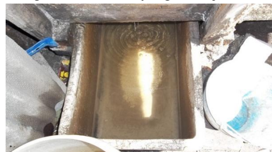
Gambar 2. Proses Penyaringan Garam Tepat Jenuh
