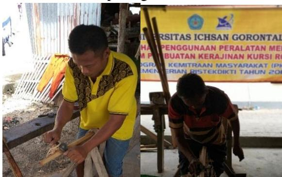
Gambar 6. Teknik Sekap Kulit Rotan Menggunakan Pisau Serut
