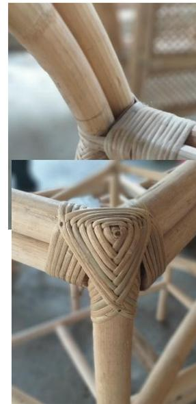
Gambar 8. Teknik mengikat ujung sambungan rotan
