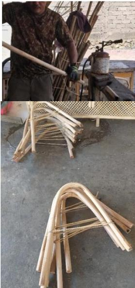
Gambar 7. Teknik bending/pelengkungan Rotan
