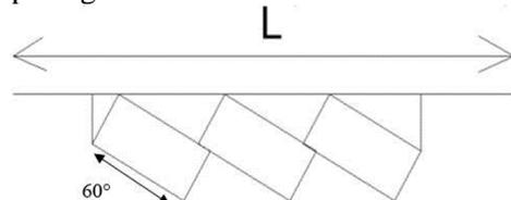
Gambar 3. Model Parkir Satu Sisi Membentuk Sudut  $60^{\circ}$
