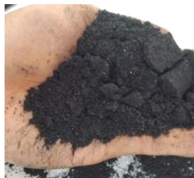
Gambar 2. Biochar yang dimodifikasi melalui aktivasi dengan MgCl^{2+}
