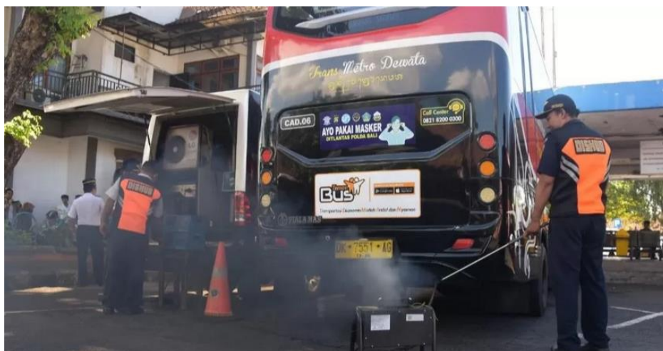
Gambar 1. Proses uji emisi di Kawasan terminal Ubung
