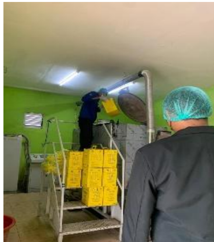
Gambar 3. Petugas melakukan proses pengolahan autoklaf (Sumber: Dokumentasi Pribadi, 2025)
