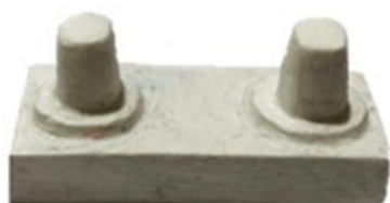
Gambar 1 : Master model 2 gigi peparasi (spesifikasi ANSI/ADA No.19)
